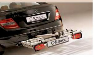
Если на креплении нет велосипедов, для доступа в багажник просто отогните вертикальный крепежный штырь.
